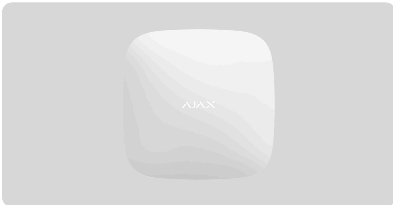
El **Hub 2** es un panel de control del sistema de seguridad Ajax que admite la verificación fotográfica de alarmas. Controla el funcionamiento de todos los dispositivos conectados e interactúa con el usuario y con la central receptora de alarmas. El dispositivo está diseñado para su instalación solo en interiores.
